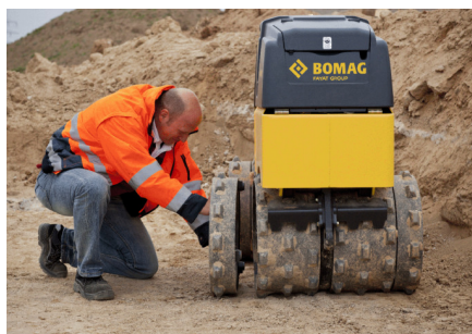
Largeurs de travail ajustables Extensions pour cylindre BOMAG
