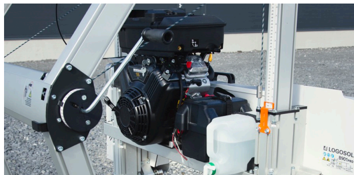
Manivelle souple : des réglages rapides et sans effort.
