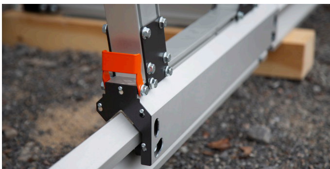
Le chariot glisse facilement sur le rail, sans aucun jeu.
